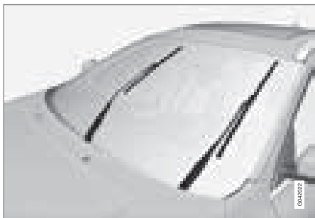
位於維修位置的雨刷片。
