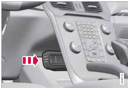
Handenhetens förvaring och laddstation.
