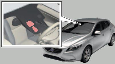
La función se conecta a velocidades inferiores a 50 Km/h y registra el tráfico delante del vehículo con un sensor de láser instalado en la parte superior del parabrisas.
