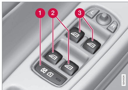
Reglagepanel i förardörr.
