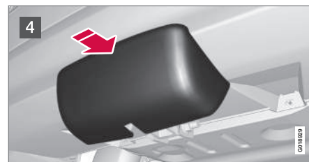
4 Skjut på skyddsskåpan tills den snäpper fast.
