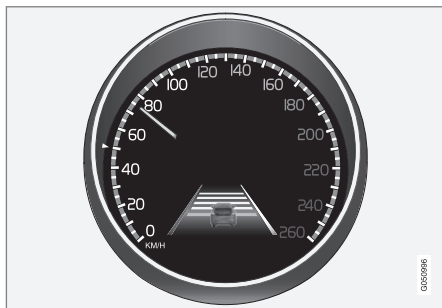
Linee laterali della funzione LDW.
