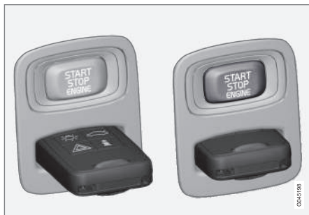
Blocchetto di accensione con chiave telecomando estratta/inserita.
