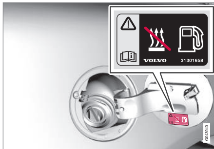
在加油口蓋板上的警示標籤
