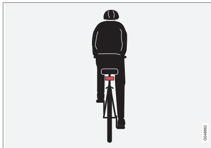
Näide sellest, mida süsteem jalgratturina tõlgendab - selged auto keskjoonele jäävad kere- ja jalgrattakontuurid otse tagant vaadatuna.
