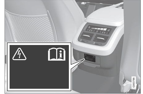
Tünel konsolundaki elektrik soketi, arka koltuk.
