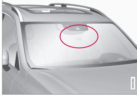
Radar ünitesi konumu
