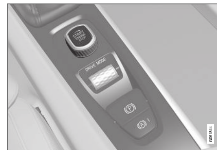
Disco de arranque na consola de túnel.
