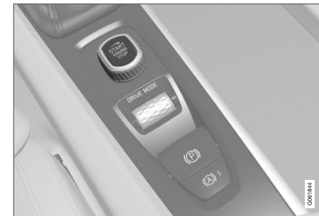
Disco de arranque na consola de túnel.
