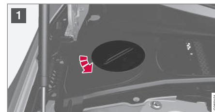
Serbatoio di espansione dell'impianto di raffreddamento, automobile con guida a sinistra.
