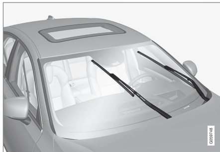
Spazzole tergicristallo in posizione di assistenza.
