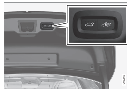
Pulsante di chiusura e bloccaggio sul bordo inferiore del baule.
