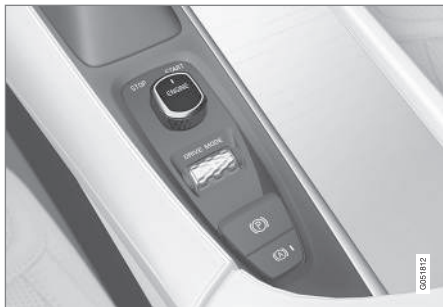
Interruttore di avviamento nel tunnel.
