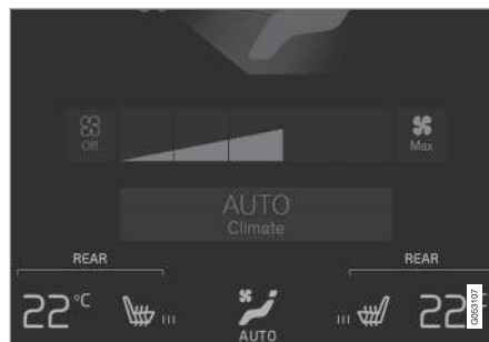
Pulsanti dei sedili elettroriscaldati nel gruppo Climatizzatore posteriore della videata climatizzatore.
