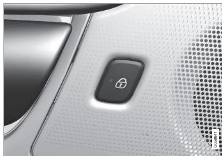
Pulsante di bloccaggio con spia indicatrice nella portiera posteriore.
