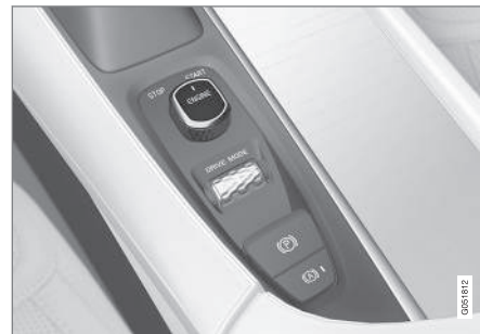
Interruttore di avviamento nel tunnel.
