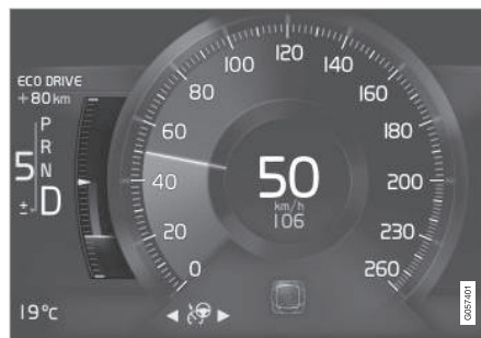
Misuratore ECO sul display del conducente da 8".
