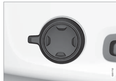
多功能控制器，位於座椅的座部側面。
