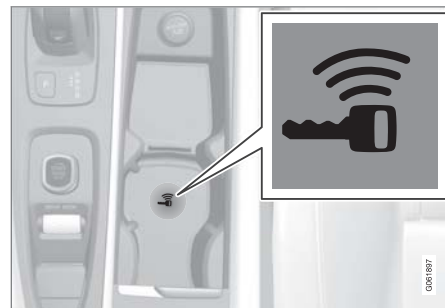
備用讀取器位於中央扶手控制台中。
