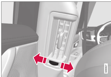
Seletor rotativo da boca de ventilação 2 .
