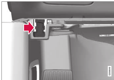
Tomada de diagnóstico (tomada On-board Diagnostic, OBDII) sob o painel de instrumentos no lado do condutor.
