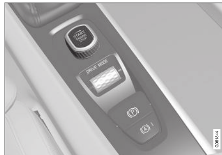
Disco de arranque na consola de túnel.
