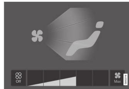
Botões do comando do ventilador na vista de climatização.
