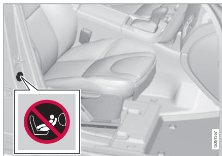
Вариант 2: Расположение наклейки для подушки безопасности на стойке двери со стороны пассажира. Наклейка для подушки безопасности видна, когда открывается пассажирская дверь.
