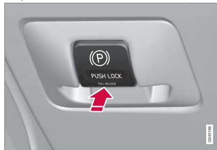
Przełącznik hamulca postojowego – włączanie.
