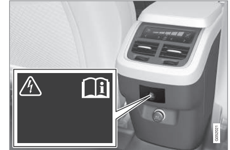
Prise électrique dans la console de tunnel de la seconde rangée de sièges.
