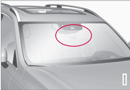
Emplacement du capteur radar.
