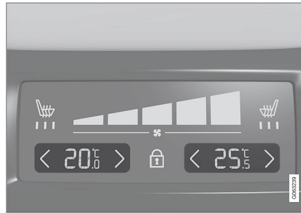
Commandes de température du panneau de climatisation arrière de la console de tunnel.
