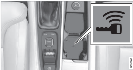
Positie back-uplezer in de tunnelconsole.
