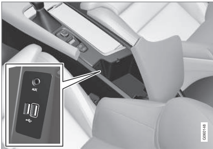
USB-aansluiting in tunnelconsole.
