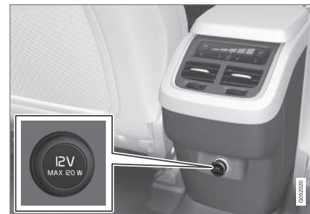
12V-aansluiting in tunnelconsole, tweede zitrij.
