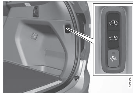
Bedieningsmechanisme voor het hoger of lager zetten van de achterkant van de auto.
