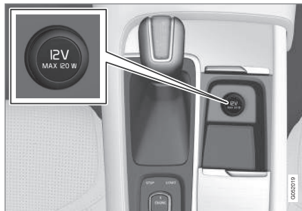
12V-aansluiting in tunnelconsole, voorin.
