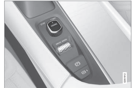
De startknop op de tunnelconsole.
