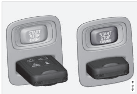
Virtalukko etäavain vedettynä ulos/painettuna sisään.
