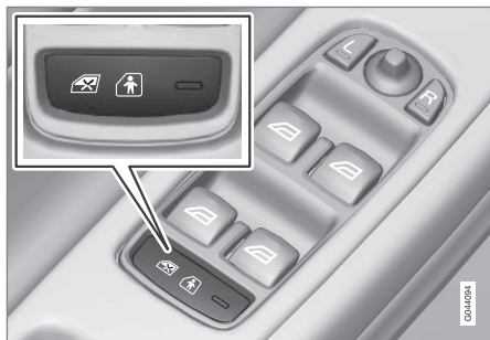
Pannello di comando nella portiera del conducente.
