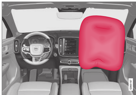
Kollisjonspute på passasjersiden i forsetet.
