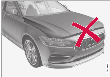
Panseret ikke helt lukket.
