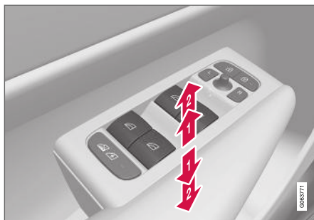
Regulering av vindusheiser.
