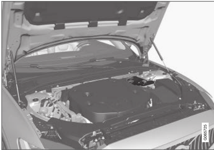
Hjelpebatteriet er plassert i motorrommet.
