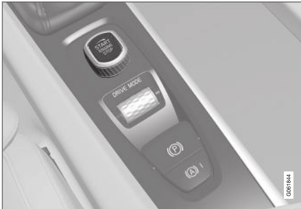
Startbryteren i tunnelkonsollen.
