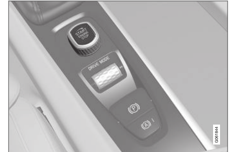
Startbryteren i tunnelkonsollen.
