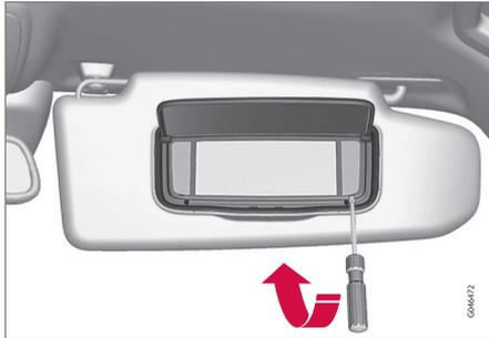
1. Introduza uma chave de fendas por baixo da lente da lâmpada e, com cuidado, levante os calços bloqueadores exercendo força na extremidade.
