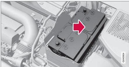
1. Instale a bateria na caixa da bateria.
