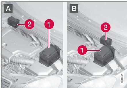
A: Modelos com volante à esquerda. B: Modelos com volante à direita. (1) Bateria de arranque<sup>16</sup>
