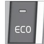
A função ECO desligada é indicada pelo símbolo **ECO** do instrumento combinado e a luz do botão ECO apagados. A função permanece desligada até ser reactivada com o botão ECO.
