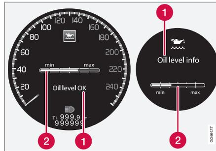
Mensagem e gráfico no mostrador. O mostrador da esquerda é apresentado no instrumento combinado digital e o da direita no analógico.
