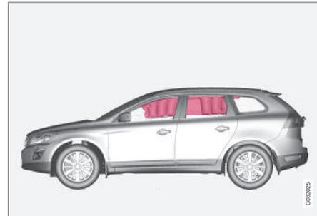
A cortina de colisão (Inflatable Curtain) faz parte do sistema SIPS (pág. 36) e do sistema de airbags (pág. 31). Está montado ao longo do forro do teto de ambos os lados e ajuda a proteger o condutor e os passageiros que vão nos lugares laterais do veículo. Perante uma colisão suficientemente forte, os sensores reagem e a cortina de colisão é insuflada.
