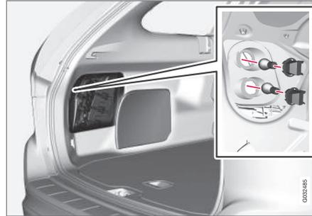
Ambas as luzes de stop e de marcha-atrás são substituídas pelo interior do compartimento da carga.
