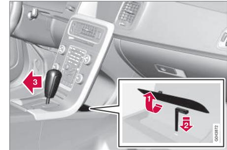
Se não for possível conduzir o automóvel, com a bateria de arranque descarregada, por exemplo, é necessário retirar o selector de mudanças da posição **P** para que seja possível deslocar o automóvel.
