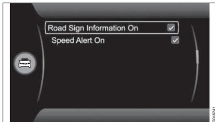
A exibição de símbolos de velocidade no instrumento combinado pode ser desligada. A função pode ser activada/desactivada no sistema de menus com **MY CAR**. Para descrição do sistema de menus, ver MY CAR (pág. 118).
