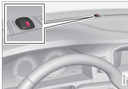
Um LED vermelho no tablier mostra o estado do sistema de alarme:
