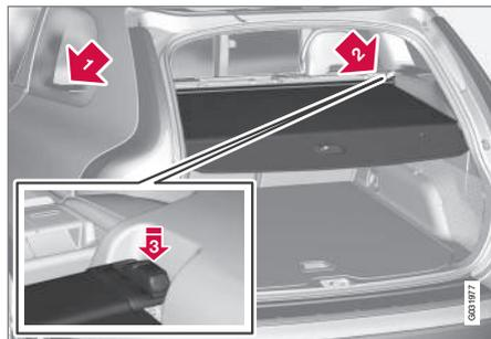
Puxe a cobertura de bagagem sobre a carga e engate-a nos encaixes junto aos pilares traseiros do compartimento da carga.
