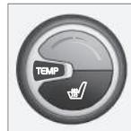
Pode-se ajustar a temperatura com o disco selector - separadamente para o lado do condutor e para o lado do passageiro.
