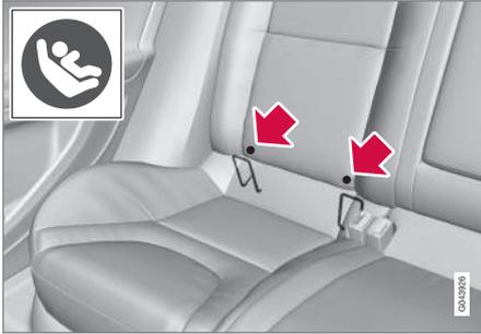
Os pontos de fixação para o sistema de fixação ISOFIX encontram-se dissimulados atrás da parte inferior das costas do banco traseiro, nos lugares exteriores.
