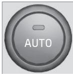
Se seleccionar uma ou várias funções manuais, as restantes funções continuam a ser comandadas de modo automático. Pressionando **AUTO** desliga-se todas as definições manuais. O ecrã exibe
