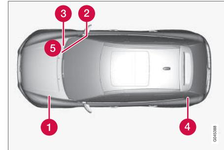
Localização das centrais eléctricas em modelos com volante à esquerda, no caso do automóvel ter volante à direita, as centrais mudam sob o lado do porta-luvas.
