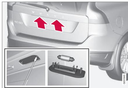
1. Solte os parafusos com uma chave de fendas.
