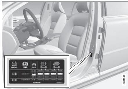
O autocolante da pressão dos pneus no pilar da porta do lado do condutor (entre a porta dianteira e traseira) indica as pressões correctas dos pneus para diferentes condições de carga e velocidades. Estas pressões também se encontram indicadas na tabela da pressão dos pneus, ver Pneus - pressão de pneus aprovada (pág. 443).
