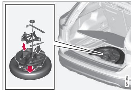
Sob o piso do compartimento da bagagem encontra-se o olhal de reboque, o macaco\* e a chave de rodas\* do automóvel. Aqui se encontram também a manga dos parafusos de segurança das rodas e a ferramenta para as cabeças de plástico dos parafusos das rodas.
