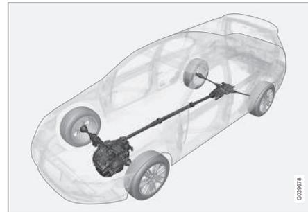
Tracção integral (All Wheel Drive) significa que todas as rodas do automóvel funcionam como motrizes em simultâneo.
