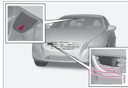
Sensor de radar e de câmara<sup>20</sup>.
