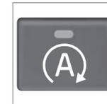
A função Start/Stop activa-se automaticamente quando o motor é arrancado com a chave. O condutor é avisado para esta situação através do símbolo da função aceso no instrumento combinado e da lâmpada acesa no botão Ligar/Desligar.
