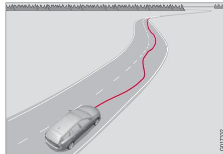
Uma câmara faz a leitura das marcações laterais pintadas na estrada e compara o desenvolvimento das marcações com os movimentos do volante executados pelo condutor. O condutor é alertado quando o veículo não acompanha a estrada de forma regular.
