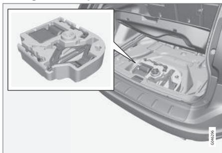
O kit de reparação de emergência de pneus furados encontra-se sob o chão do compartimento da carga.
