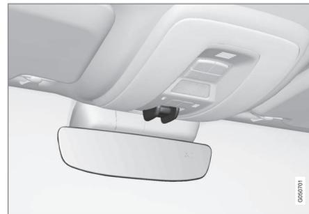
O tecto panorâmico e a cortina são accionados com um comando que se encontra no tecto. O comando é activado na posição de ignição **I** ou **II**, ver Posições de ignição - funções nos diferentes níveis (pág. 82).
