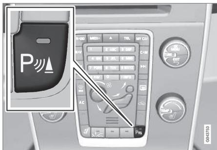
Ligar/Desligar os sensores da Assistência ao estacionamento e do CTA.
