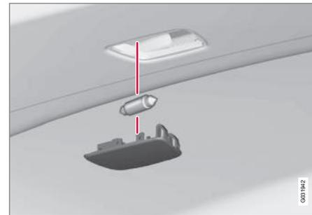
1. Introduza uma chave de fendas e force ligeiramente de modo a soltar o cárter das lâmpadas.
