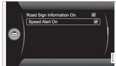
O condutor pode seleccionar se pretende obter um aviso quando o limite de velocidade é ultrapassado em 5 km/h ou mais. O aviso é efectuado através de um símbolo a piscar com a velocidade máxima aplicável enquanto a mesma é ultrapassada. A função pode ser activada/desactivada no sistema de menus com **MY CAR**. Para descrição do sistema de menus, ver MY CAR (pág. 118).
