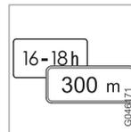
Algumas velocidades são válidas após, por exemplo, um determinado trajecto ou durante determinadas horas do dia. O condutor é alertado para estas condições com um símbolo de sinal adicional sob o símbolo com a velocidade.
