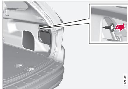
1. Abra/remova a tampa lateral no compartimento da carga (no mesmo lado da tampa do depósito de combustível) e procure um cabo verde com uma pega.
