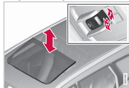
Posição de ventilação, vertical na margem traseira.
