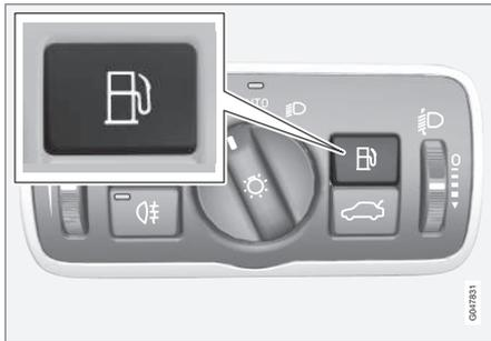
Abra a tampa do depósito de combustível com o botão no painel de iluminação - a tampa abre-se ao soltar o botão.
