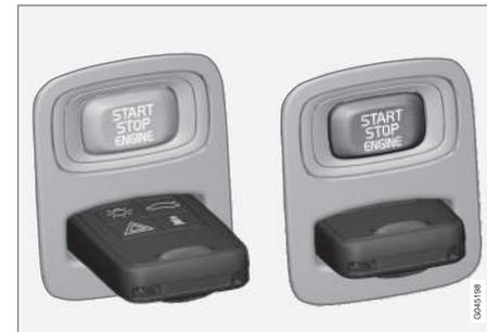
*Interruptor de ignição com o comando à distância ejectado/inserido.*
