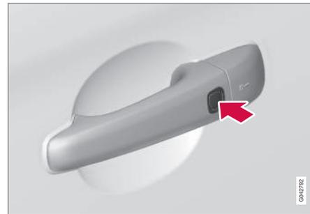
Automóveis com sistema de Condução sem Chave possuem um botão no puxador exterior das portas.
