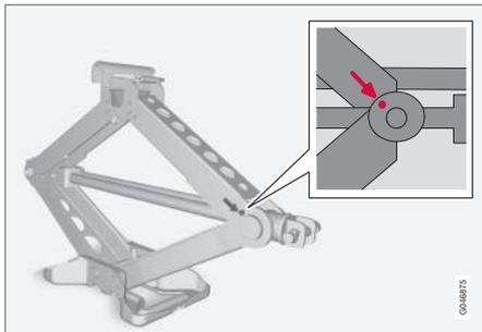
Após a utilização da ferramenta e do macaco\* estes devem ser acondicionados de forma correcta. O macaco deve ser enroscado para a posição correcta para ser guardado.
