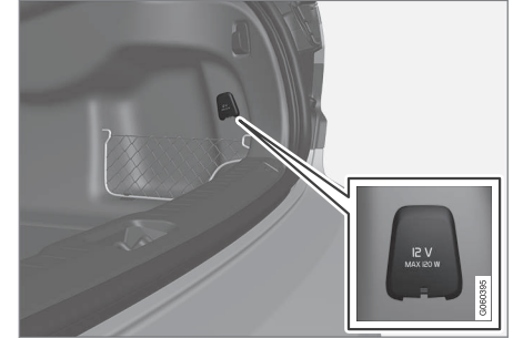
Kargo alanındaki 12 V elektrik soketi*.
