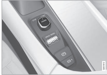
Tünel konsolundaki çalıştırma düğmesi.
