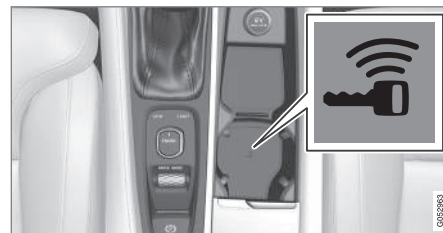
Positie back-uplezer in de tunnelconsole.
