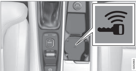
Positie back-uplezer in de tunnelconsole.
