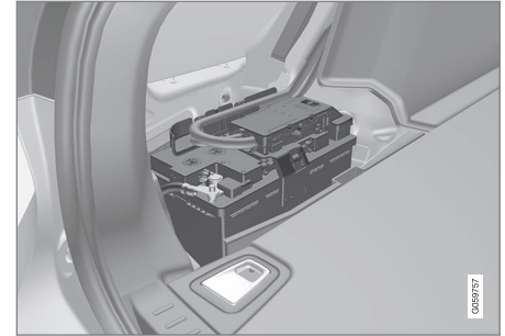
De startaccu zit in de bagageruimte.
