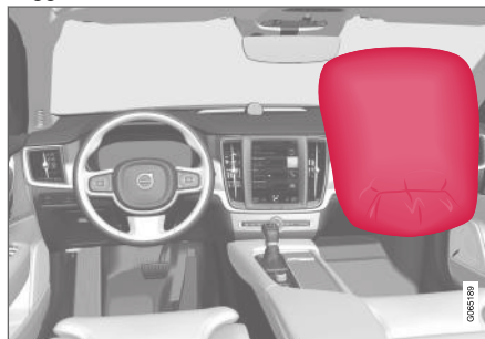
Airbag nel sedile anteriore sul lato passeggero.
