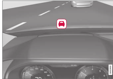
Simbolo dell'indicatore di collisione sul parabrezza 66 .
