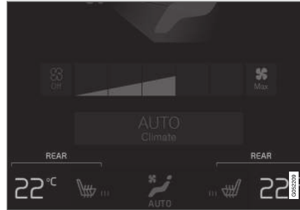
Pulsanti di temperatura nella scheda Climat. posteriore della videata climatizzatore.
