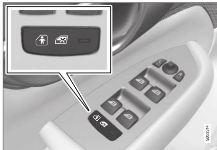
Pulsante di attivazione e disattivazione elettrica.
