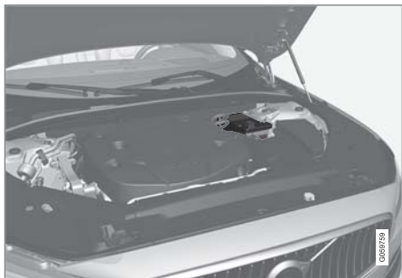
支援電瓶位於支撐桿旁的電瓶箱中。
