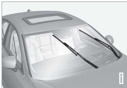
位於維修位置的雨刷片。
