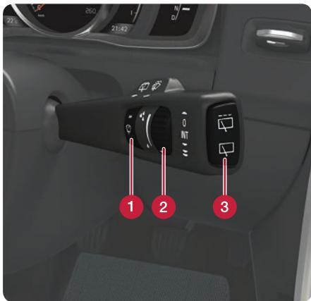
レバーを下方向に動かすとウインドスクリーンワイパーが連続作動し、上方向に動かすと1回だけ作動します。
