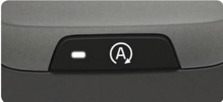
ボタンのランプとコンパインド・メーター・パネルのシンボルが点灯し、機能が作動していることを示します。
