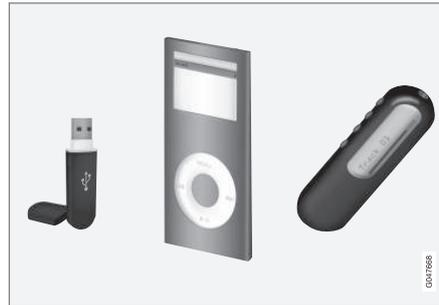
Une source sonore connectée à l'entrée USB peut alors être gérée<sup>17</sup> avec les commandes audio de la voiture. Une unité connectée via l'entrée AUX ne peut pas être commandée via la voiture.
