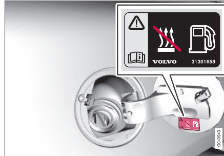
Varningsdekal på tankluckan.
