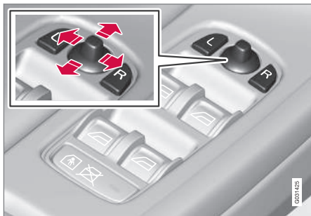
Reglage för yttre backspeglar.
