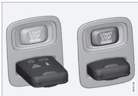
Blocchetto di avviamento con telecomando estratto/ inserito e pulsante START/STOP ENGINE .
