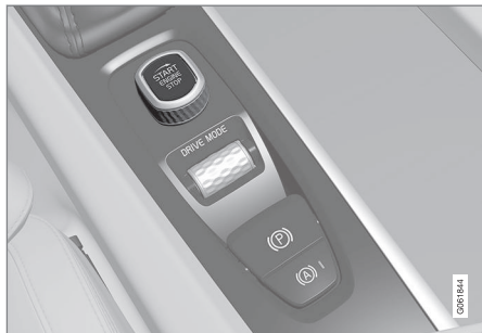
Interruttore di avviamento nel tunnel.
