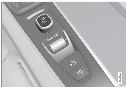
Interruttore di avviamento nel tunnel.
