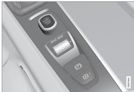
Interruttore di avviamento nel tunnel.
