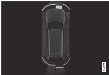
Bildskärmsvy med hinderzoner och sensorsektorer.
