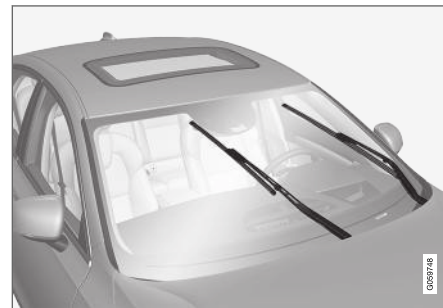
Torkarblad i serviceläge.
