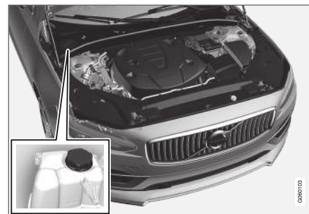
Expansionskärl för kylsystem, vänsterstyrd bil.
