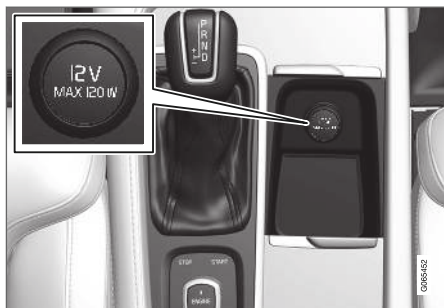
12 V-eluttag i tunnelkonsol, framsäte.
