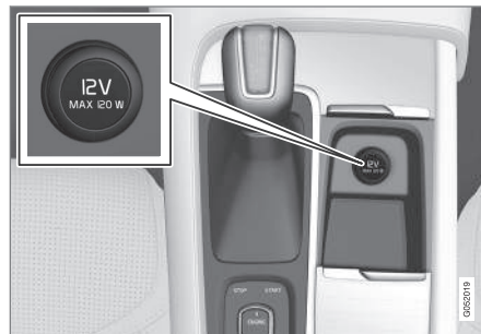
Tomada eléctrica 12 V na consola de túnel, banco dianteiro.
