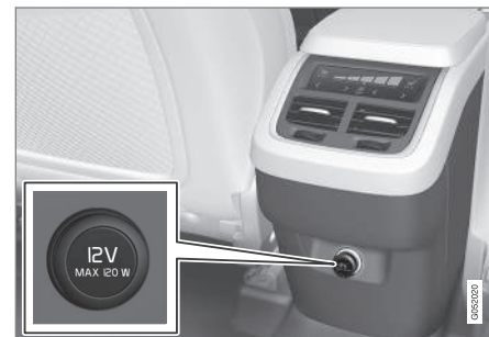
Tomada eléctrica 12 V na consola de túnel, segunda fila de bancos.
