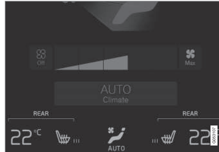
Botões para bancos com aquecimento eléctrico no grupo Climatização traseira na vista de climatização.
