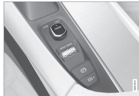
Disco de arranque na consola de túnel.
