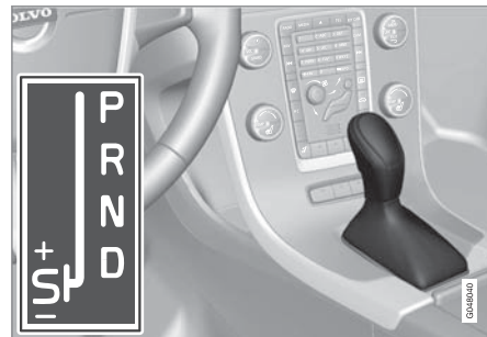
D: オートマチックギヤポジション。+/-: マニュアルギヤポジション。S: スポーツモード*
