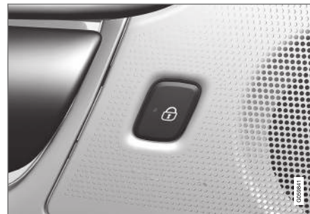
Knap til låsning i bagdør med indikeringslampe.
