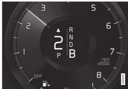
Gearskiftindikator på førerdisplayet 2 .
