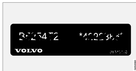
④ Mærkat med motorkode og motorens løbenummer.
