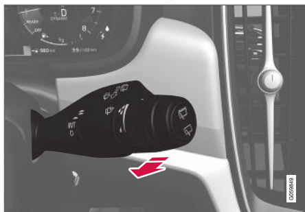
Sprinklerfunktion, højre kontaktarm.
