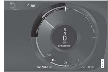
مقياس Eco في شاشة السائق قياس ١٢ بوصة*.
