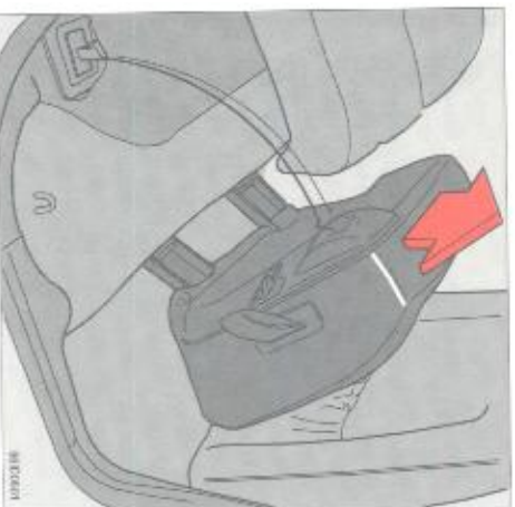
Zitting tegen de voorstoelen opklappen en zitting verwijderen
