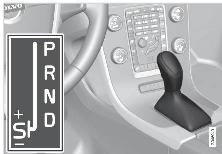
D: polohy automatického řazení. +/-: polohy manuálního řazení. S: sportovní režim*.
