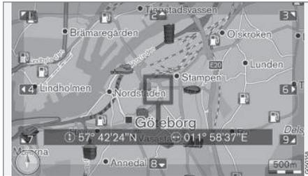
En position de Défilement, vous pouvez déplacer un réticule<sup>1</sup> sur la carte à l'aide des boutons numériques de la console centrale.
