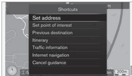
Le système de navigation dispose d'un menu et de raccourcis pour les fonctions les plus fréquemment utilisées.
