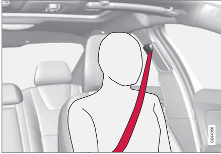
حزام الأمان مُركَّب بشكل صحيح.
