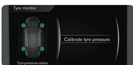
Il est toujours nécessaire d'effectuer un étalonnage après le remplacement d'un pneu ou un changement de la pression de gonflage. Lorsque le témoin ( ) s'allume, il convient de contrôler la pression de gonflage et d'étailler le système. Procédez comme suit :
