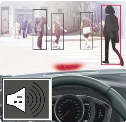
La voiture est pourvue d'un Système d'anticipation de collision avec frein automatique et détection de cyclistes et piétons, capable d'alerter, de freiner et/ou de s'arrêter face à un véhicule, des cyclistes et des piétons.
