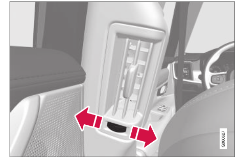
Molette de bouche de ventilation 2 .
