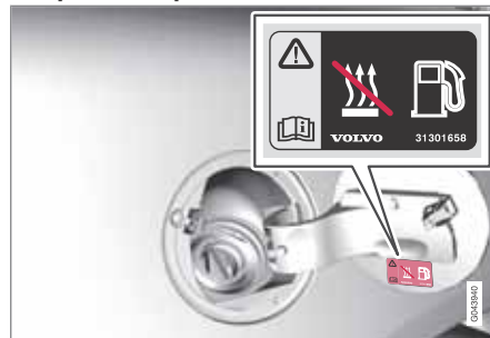
Etykieta ostrzegawcza na pokrywie wlewu paliwa.
