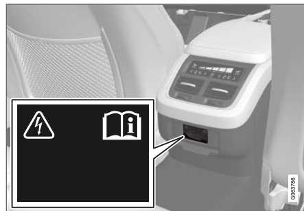
Sähköliitäntä tunnelikonsolissa, takaistuin.
