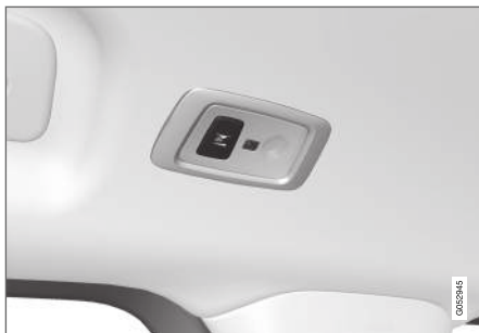
Panoraamakatolla* varustetussa autossa on kaksi valoyksikköä, yksi katon kummallakin puolella.
