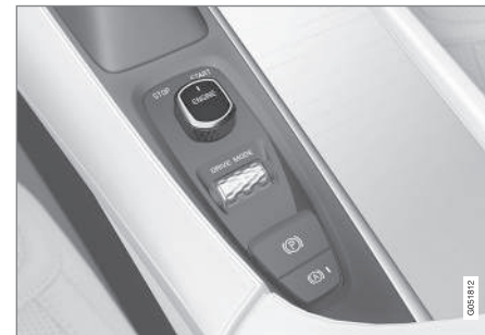
Pokrętło rozruchu na konsoli między fotelami.
