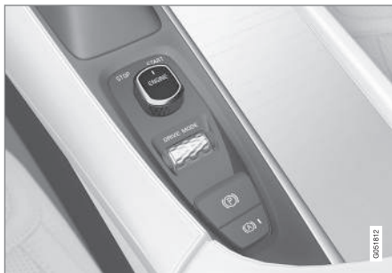
Pokrętło rozruchu na konsoli między fotelami.
