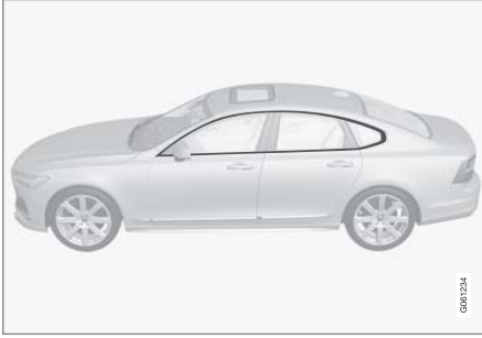
الأجزاء التي ينبغي غسلها باستخدام عصير تنظيف يحتوي على قيمة pH تتراوح بين ٣,٥ و ١١,٥.
