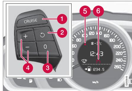
Tastiera al volante e display di un'automobile **senza** limitatore di velocità<sup>5</sup>.
