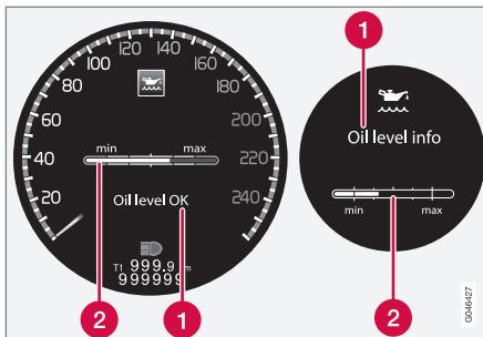
*Messaggio e grafico sul display. Il display sinistro mostra il quadro strumenti digitale e quello destro il quadro strumenti analogico.*
