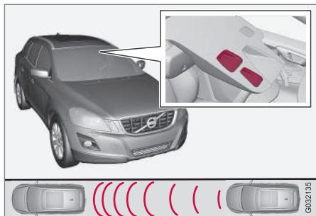
Se la differenza di velocità rispetto al veicolo antistante è di 4-15 km/h, City Safety™ è in grado di evitare la collisione.
