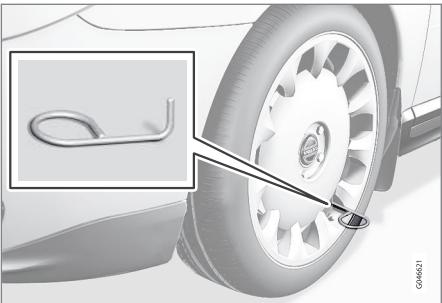
5. Avvitare a fondo l'occhiello di traino con la chiave per i dadi delle ruote\* come illustrato di seguito.
