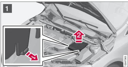
**1** Piegare verso l'esterno i fermi sui lati della copertura della batteria di avviamento.
