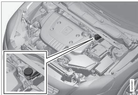
Il serbatoio dell'olio è collocato sul lato conduttore.
