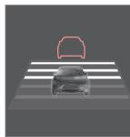
È possibile selezionare diverse distanze temporali dal veicolo antistante, che vengono visualizzate sul quadro strumenti con 1-5 linee orizzontali - più linee sono visualizzate, mag-
