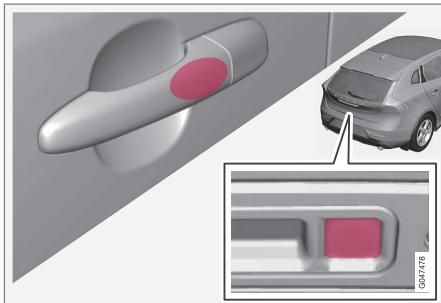
Bloccare le portiere e il portellone agendo su una delle maniglie delle portiere o premere leggermente il pulsante gommato piccolo fra i due del portellone. La spia di bloccaggio (p. 162) sul parabrezza inizia a lampeggiare a conferma del bloccaggio.
