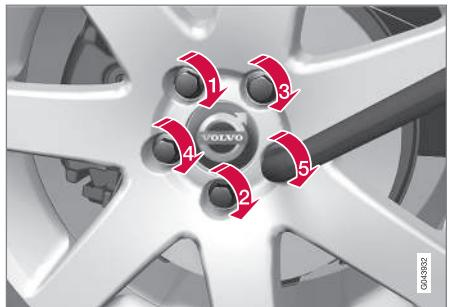
4. Serrare i dadi della ruota in sequenza. È importante serrare i dadi della ruota alla coppia corretta. Controllare la coppia con una chiave torsiommetrica.
