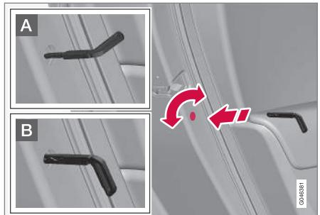
*Fermo di sicurezza per bambini manuale. Da non confondere con il Bloccaggio manuale della portiera (p. 175).*
