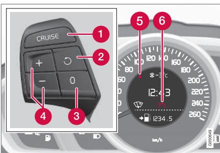
Tastierina al volante e display di un'automobile senza limitatore di velocità<sup>7</sup>.
