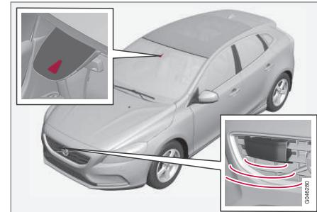
Sensore telecamera e radar<sup>25</sup>.
