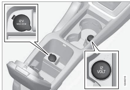
Presa da 12 V nel tunnel, sedile anteriore.
