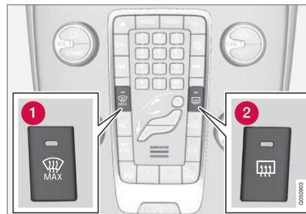
**1** Riscaldamento elettrico del parabrezza
