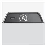
La funzione Start/Stop si attiva automaticamente all'accensione del motore con la chiave. Il conducente viene avvertito dello stato della funzione mediante la breve accensione della spia del pulsante ON/OFF sul quadro comandi combinato e l'accensione della spia nel pulsante ON/OFF.
