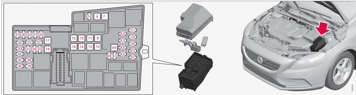
All'interno della copertura è collocata una pinza che semplifica la rimozione e l'installazione dei fusibili.
