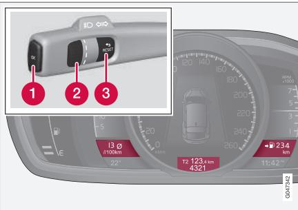
Possono essere visualizzati simultaneamente tre titoli del computer di bordo - uno in ciascuna "finestra".
