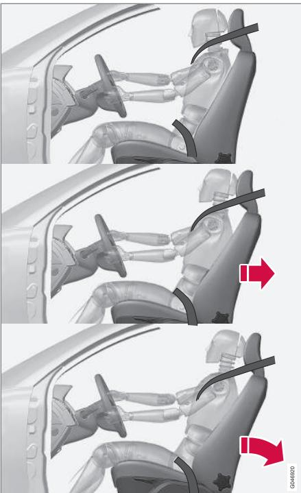
Il sistema WHIPS viene attivato in caso di tamponamento, secondo l'angolo di collisione, la velocità e le caratteristiche del veicolo che entra in collisione.
