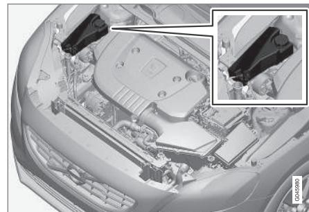
Per il rabbocco, seguire le istruzioni riportate sulla confezione. È importante dosare le quantità di refrigerante e acqua in base al clima. Non rabboccare mai soltanto con acqua. Il rischio di congelamento sussiste sia in caso di quantità insufficiente che eccessiva di refrigerante.
