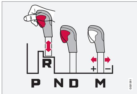
La leva può essere portata liberamente in avanti o all'indietro tra **N** e **D**. Le altre posizioni hanno un blocco che viene manovrato tramite il pulsante di bloccaggio sulla leva selettrice.
