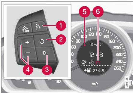
Tastiera al volante e quadro strumenti di un'automobile **con** limitatore di velocità<sup>4</sup>.
