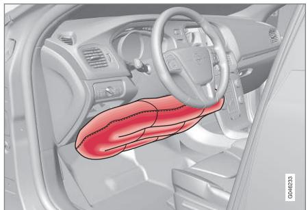
Airbag paraginocchia lato conducente nell'automobile con guida a sinistra.
