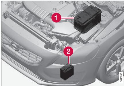
(1) Batteria di avviamento<sup>17</sup> (2) Batteria ausiliaria
