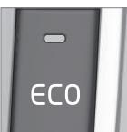
Se la funzione ECO è attivata, il motore potrebbe spegnersi automaticamente prima che l'automobile si ferma.
