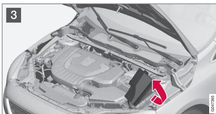
**3** Inclinare la copertura verso il motore per accedere ai fusibili.
