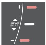
Indicatore cambio di marcia per cambio manuale. È acceso un solo cursore per volta - durante la guida normale è acceso solamente quello centrale.
