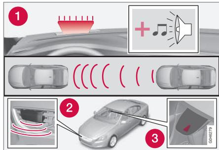
1. Spia di allarme e segnale acustico dell'indicatore di collisione<sup>11</sup>.
