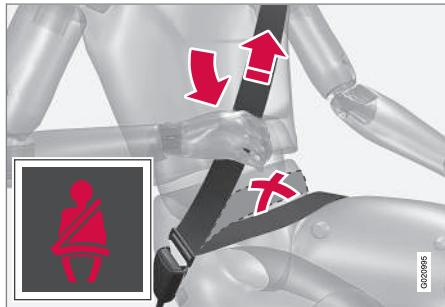
Tendere la sezione lombare sui fianchi tirando la sezione diagonale in alto verso la spalla. La sezione lombare deve rimanere bassa (non sopra l'addome).
