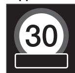
Un simbolo per l'insegna supplementare sotto forma di un riquadro vuoto sotto il segnale di velocità del quadro strumenti, sta ad indicare che RSI ha rilevato un cartello aggiuntivo con informazioni di completamento per il limite di velocità in questione.
