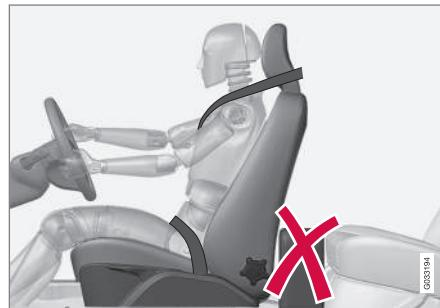
Non sistemare sul pavimento dietro il sedile di conducente/passeggero alcun oggetto che possa compromettere la funzionalità del sistema WHIPS.
