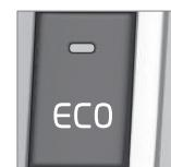
Alla disattivazione della funzione ECO, la spia ECO sul quadro strumenti e la spia nel pulsante ECO si spengono. La funzione rimane disattivata finché non viene riattivata con il pulsante ECO.
