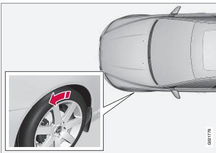
La freccia indica il senso di rotazione del pneumatico.
