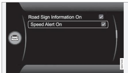
Il conducente può attivare un avvertimento che viene fornito qualora si superi il limite di velocità di 5 km/h o più. L'avvertimento è rappresentato dal lampeggiamento del simbolo del limite di velocità per tutto il tempo in cui detta velocità è superata.
