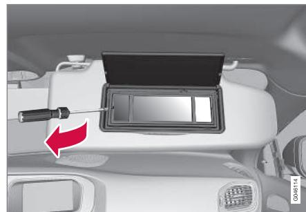
1. Inserire un cacciavite sotto la lente della lampadina e sollevare con cautela il fermo sul bordo.
