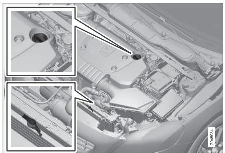
Asta di livello e tubo di rifornimento.
