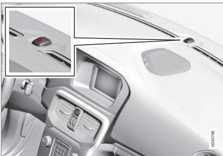
*Lo stesso diodo usato per l'indicatore di bloccaggio (p. 162).*
