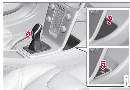
Se non è possibile guidare l'automobile, ad esempio perché la batteria di avviamento è scarica, occorre deselezionare la posizione **P** della leva selettrice per spostare l'automobile.
