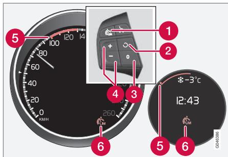
Tastiera al volante e quadro strumenti Digital o Analog.
