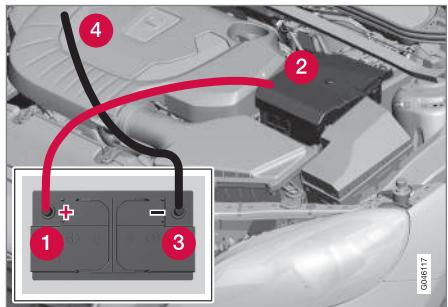
Quando si impiega una batteria ausiliaria, attenersi ai seguenti passaggi per evitare il rischio di cortocircuito o altri danni:
