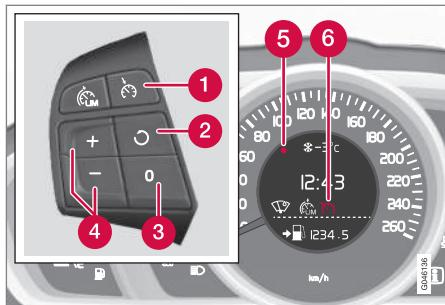
Tastiera al volante e display di un'automobile con limitatore di velocità<sup>5</sup>.
