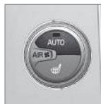
Ruotare la manopola per aumentare o ridurre la velocità della ventola, **AUTO** viene disinserito. Se si seleziona **AUTO**, la velocità della ventola si regola automaticamente (p. 134) - la velocità della ventola precedentemente impostata viene disinserita.
