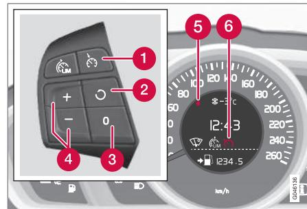
Tastierina al volante e display di un'automobile con limitatore di velocità<sup>8</sup>.
