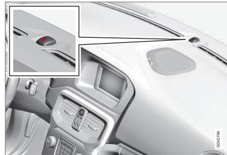
Lo stesso diodo usato per l'indicatore di allarme (p. 183).
