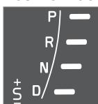
Le posizioni del cambio automatico sono indicate nella parte destra del quadro comandi combinato (è acceso un solo cursore per volta, quello della posizione in cui si trova attualmente la leva selettrice).
