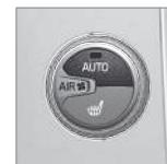
La funzione regola automaticamente temperatura (p. 135), climatizzatore (p. 135), velocità della ventola (p. 134), ricircolo (p. 137) e distribuzione dell'aria (p. 129).
