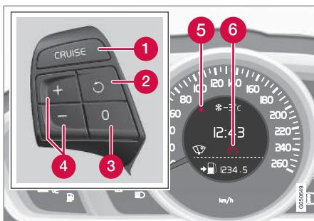
Tastiera al volante e quadro strumenti di un'automobile **senza** limitatore di velocità<sup>4</sup>.
