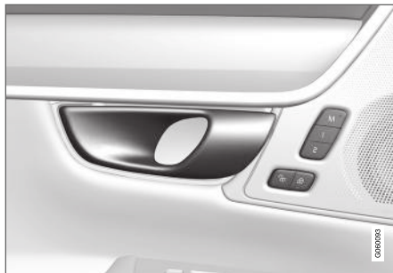
Åbningshåndtag til alternativ oplåsning i sidedør.
