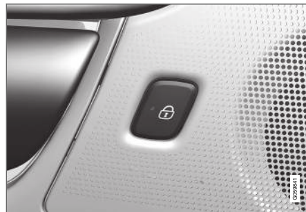
Knap til låsning i bagdør med indikeringslampe.
