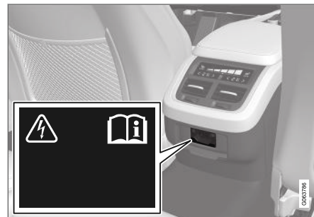
Stikkontakt i tunnelkonsol, bagsæde.
