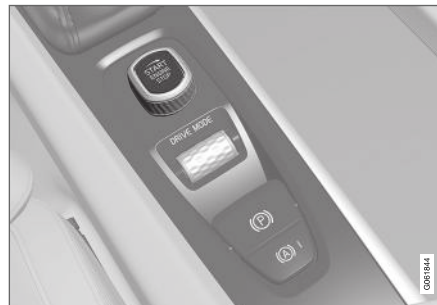
Startknappen i tunnelkonsollen.
