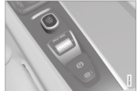
Startknappen i tunnelkonsollen.
