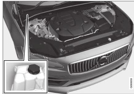
Ekspansionsbeholder for kølesystemet, højrestyret bil.
