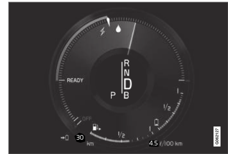
Førerdisplayet ved fremdrift med både el- og forbrændingsmotor.
