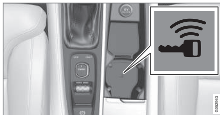
Umístění záložní čtečky v tunelové konzole.
