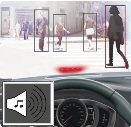
Das Fahrzeug verfügt über ein Unfallwarnsystem mit Bremsautomatik sowie Fußgänger- und Radfahrererkennung, das vor Fahrzeugen, Radfahrern und Fußgängern warnen sowie das Fahrzeug abbremsen und/oder zum Stehen bringen kann.
