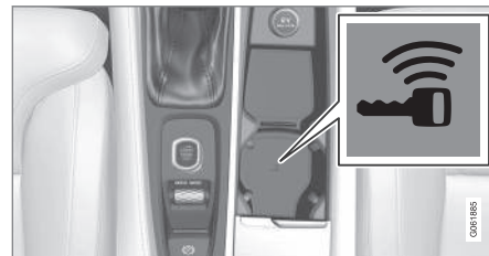
Positie back-uplezer in de tunnelconsole.
