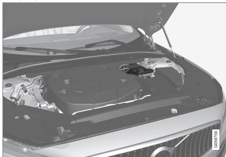
De hulpaccu van 12 V zit in een bak naast de veerpootbevestiging.
